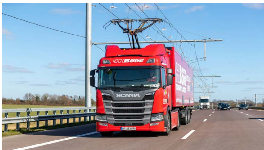
Oberleitungs-LKW, 5 km Teststrecke auf der A1 zwischen Reinfeld und Lübeck, 2021.
